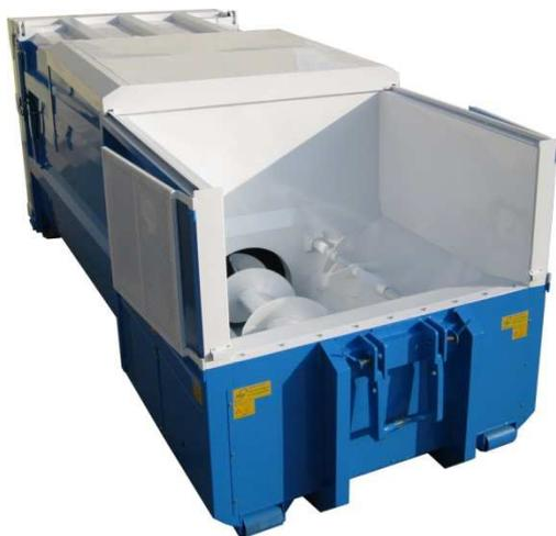
Fig. 3 Compattatore a coclea per cartone
