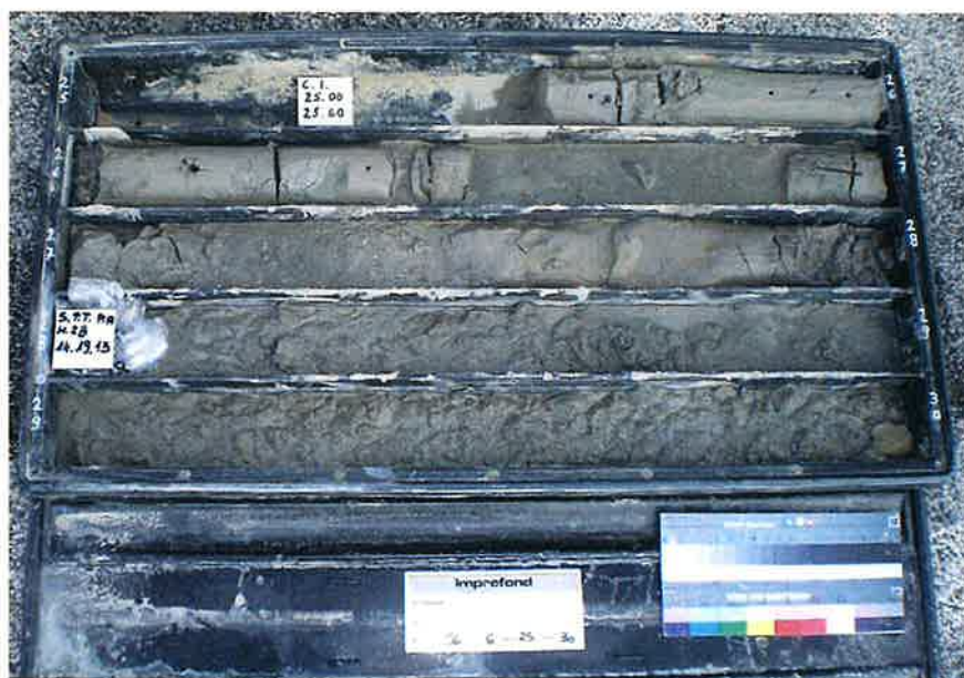
Figura 6 – Cassetta catalogatrice - carotaggio in terreni
