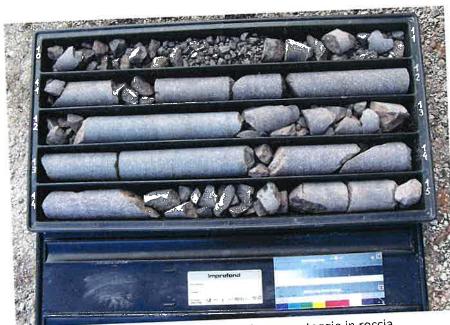
Figura 7 – Cassetta catalogatrice – carotaggio in roccia
