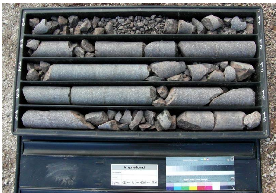
Figura 7 – Cassetta catalogatrice – carotaggio in roccia
