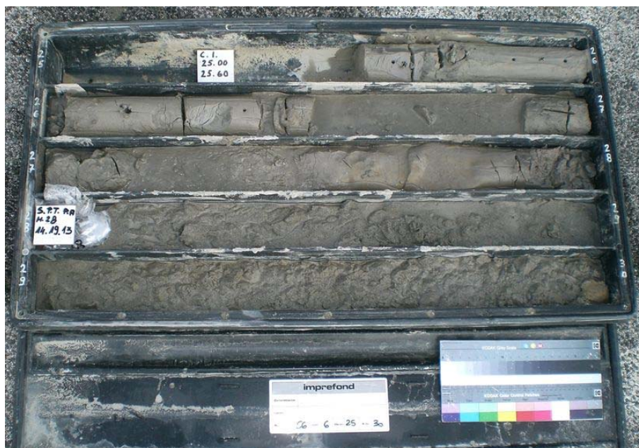
Figura 6 – Cassetta catalogatrice - carotaggio in terreni
